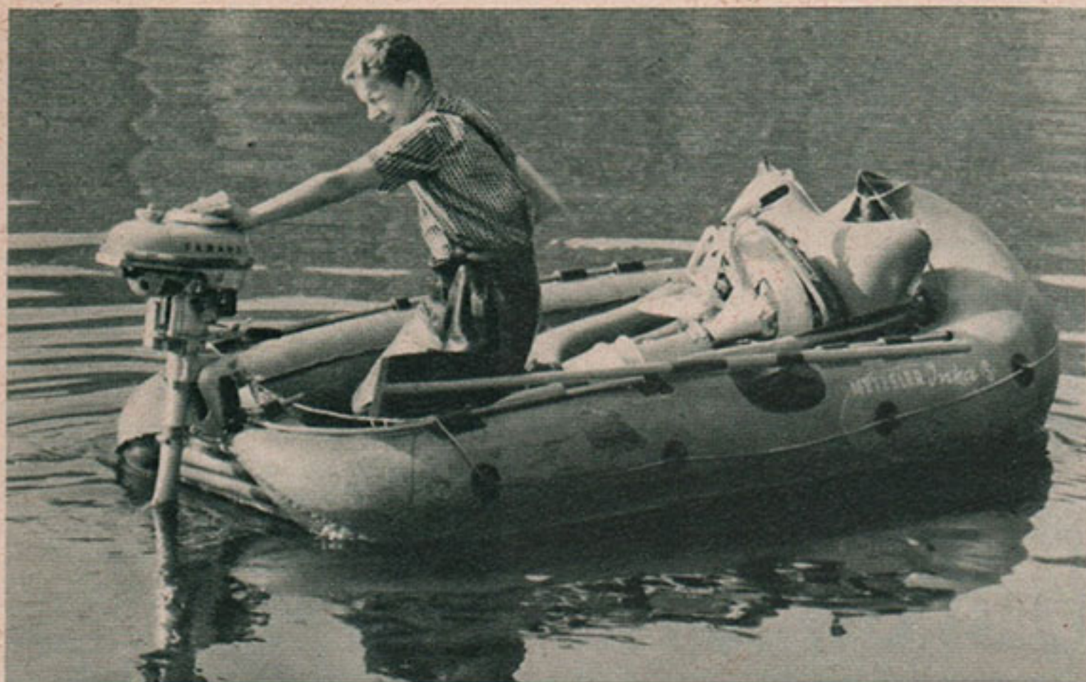
Damit das Boot vorn nicht zu hoch kommt, hat Volker den Suzuki-Motor mit eingeladen. Mit dem Zugseil, das sich automatisch wieder aufwickelt, wird der Motor angeworfen.
