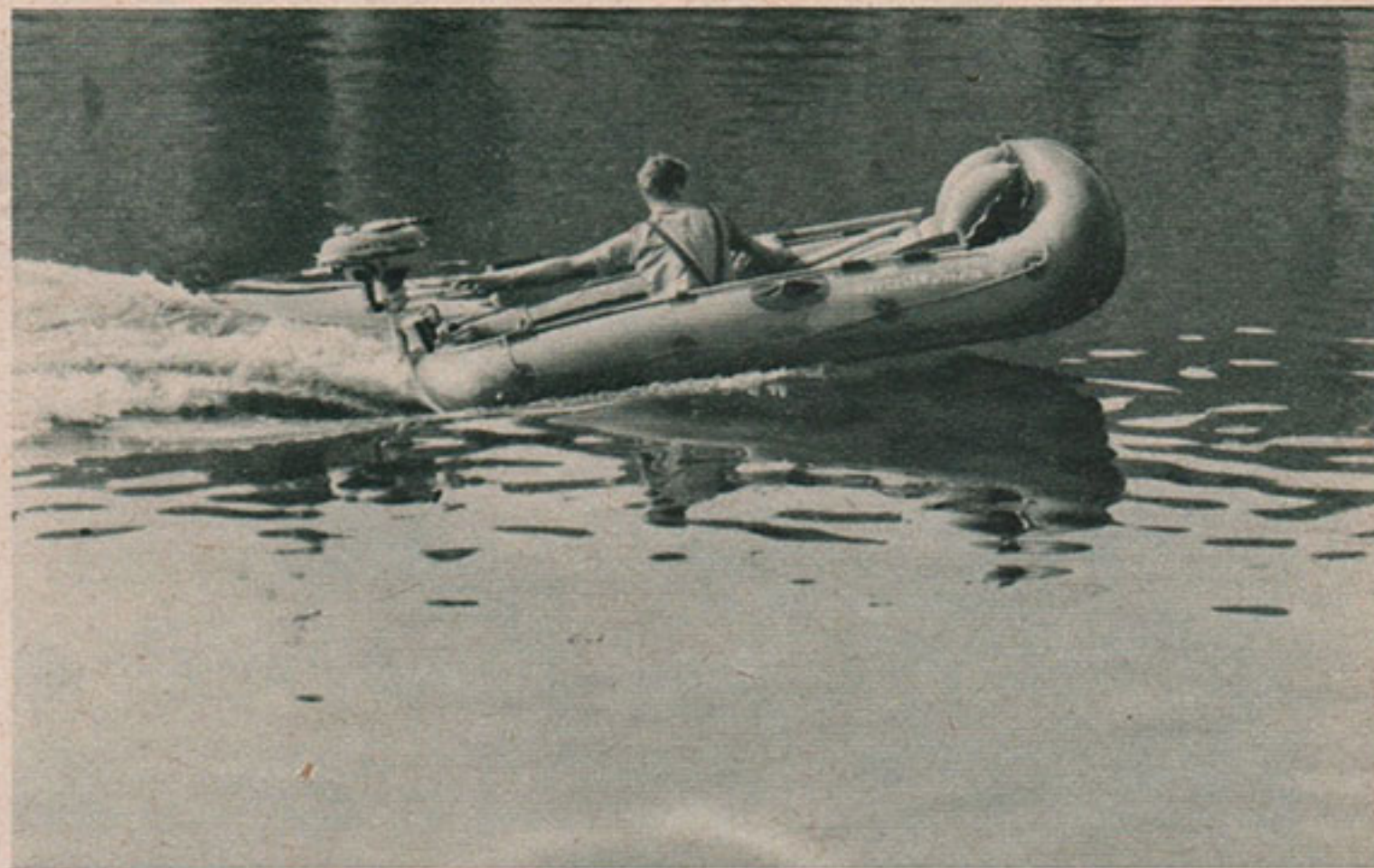
So etwa liegt das Inka-S bei schneller Fahrt mit einer Person und wenig Ballast, wenn die Gewichtsverteilung richtig ist und der Motor den richtigen Neigungswinkel hat.
