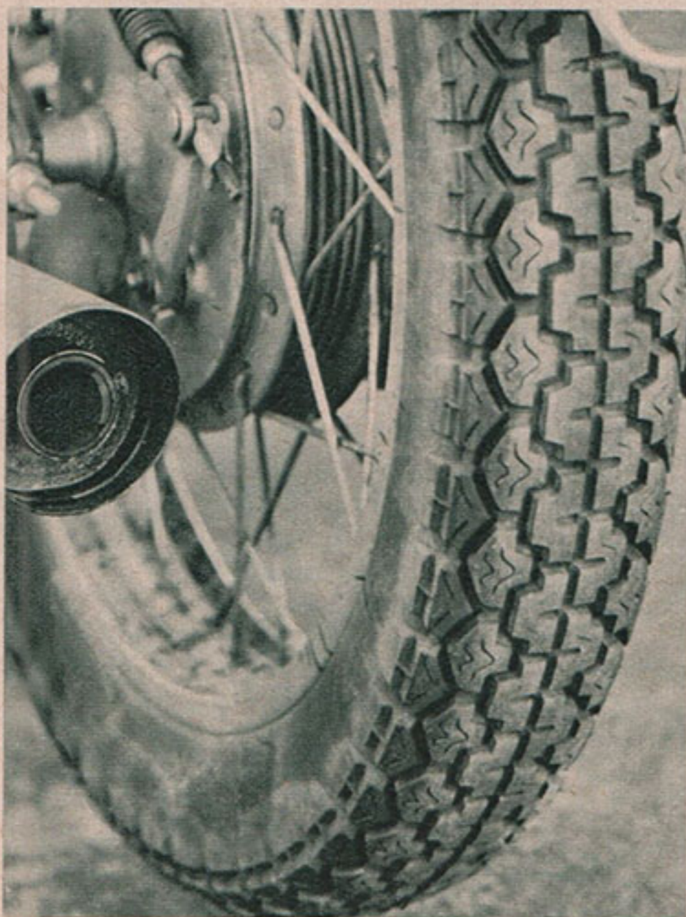
In den „Rennrüten“ befinden sich die sehr wirksamen Schalldämpfer-Einsätze. Der in Japan in Lizenz gefertigte Reifen Dunlop K 70 auf dem Hinterrad hat an den Außenkanten eine Zickzack-Profilierung.
