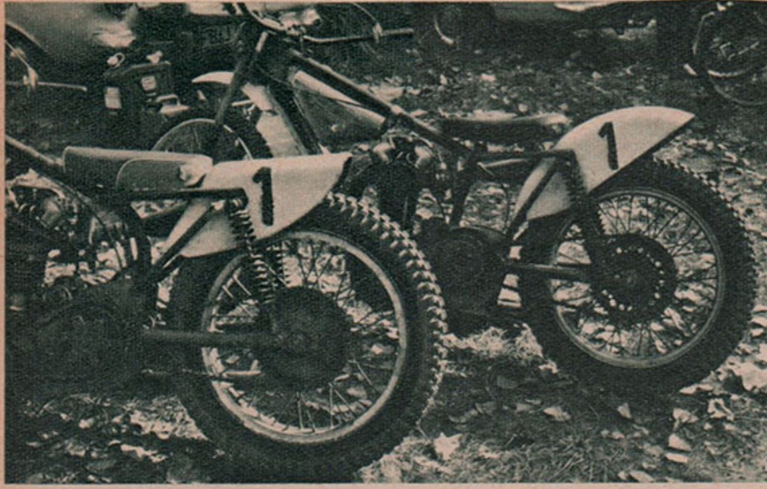
Bei den Solisten werden neben zahlreichen Eigenbauten vornehmlich die Rahmen von Alf Hagon (Bild 3) oder die Konstruktion von Hofmeister (Bild 4) gefahren. Während Hagon konventionell baut, verwendet Hofmeister zur Federung der Schwinge eine zentrale Schraubenfeder mit nur einem Dämpfer.
