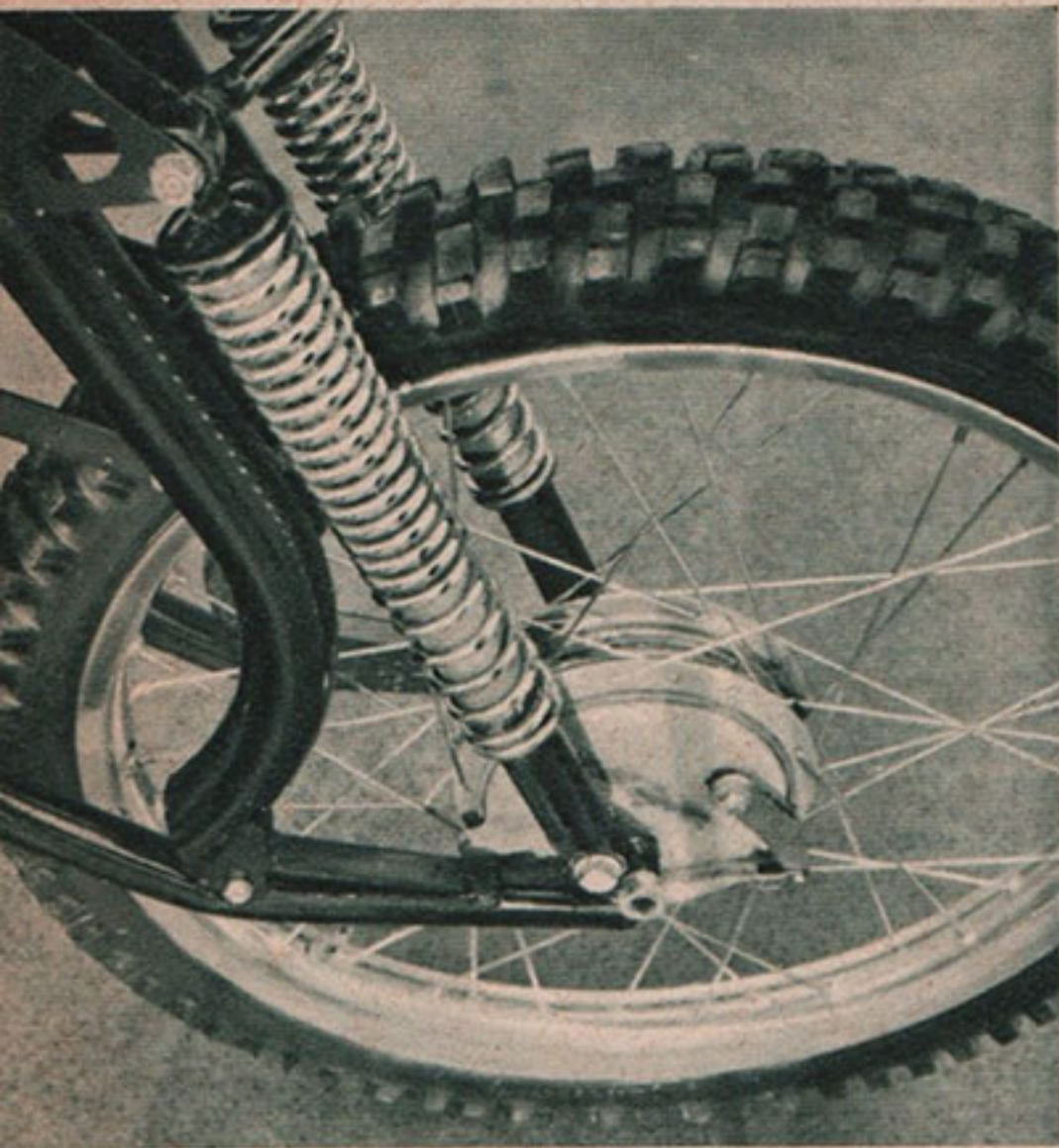
Alle GS-Modelle haben jetzt schon die zukünftig auch bei den Serienfahrzeugen verwendeten großen Leichtmetall-Sachs-Bremsnaben.
