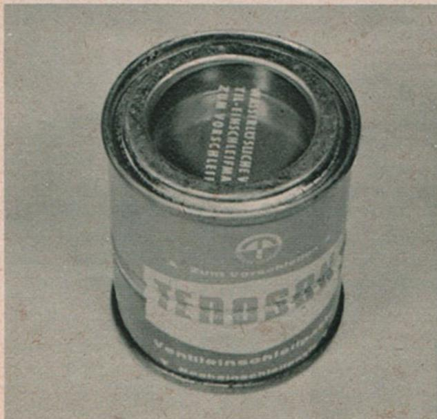
Ventilschleifpaste wird mit Wasser weggespült, nicht mit Benzin! Wenn sie etwas zu dick geworden ist, hilft also auch nur Verdünnen mit Wasser. Die Packungen enthalten immer zwei verschiedene Körnungen der Paste, eine für Vorschleif in recht grober Korngröße und eine feine für den Fertigschliff.
