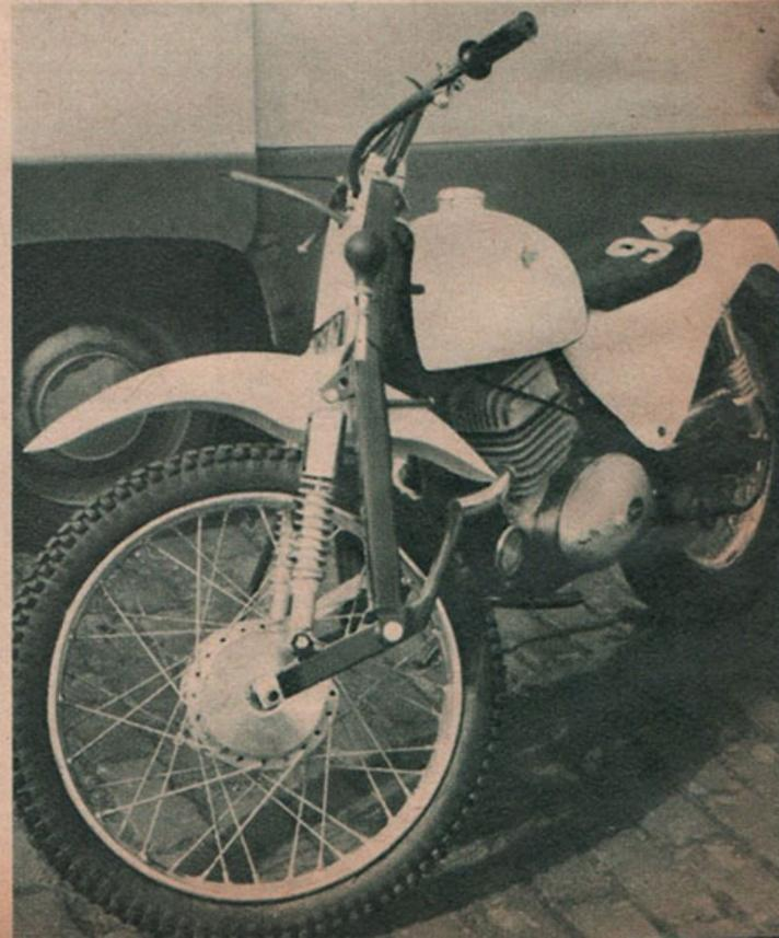
Kunststoff als Material für Kotflügel und Tanks. Derartige „sets“ gibt es für alle käuflichen Trialmodelle in England. Kunststoff erträgt Schwingungen besser als Blech, dröhnt weniger, ist leichter und läßt sich zudem gut reinigen.
