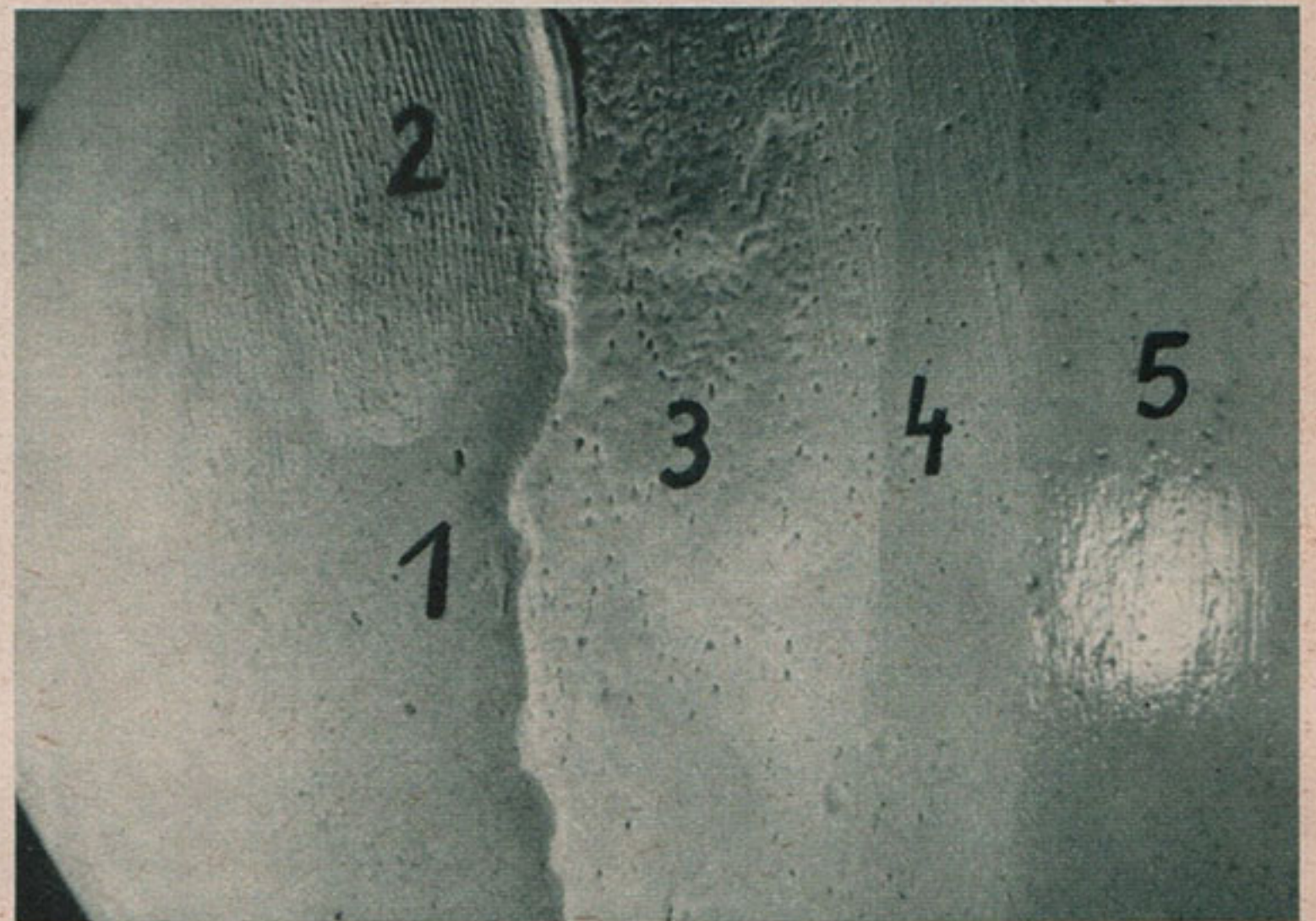
Die einzelnen Arbeitsgänge für die Gipsform sind hier mit Ziffern angedeutet: 1 ist die rohe Oberfläche, nur mit dem Messer auf Form gebracht, Poren und Lunken sind noch vorhanden. Bei 2 wurde (da nur feine Poren auszufüllen waren) die Moltofillschicht sehr dünn aufgetragen und mit dem Finger glattgestrichen (die Rillen sind Spuren der „Fingerabdrücke“). Bei 3 wurde die Zellospachtelschicht wesentlich dicker aufgetragen, hier sind unter dieser Schicht große Poren. Ubrigens wurde die Füllmasse schlecht angesetzt, sie bekam beim Trocknen wieder Blasen, also sorgfältig durchrühren. 4 ist eine schmale Zone, in der der Oberflächenverputz bereits abgeschmirgelt wurde und die 5 steht schon auf der Lackschicht, die als nächstes dann den Trennmittelauftrag bekommt. Im ganzen sind, außer der Gestaltung der Form immerhin 6 Arbeitsgänge sehr geduldig durchzuführen, bevor der Anfang mit Kunstharz gewagt werden kann. Unten: so sieht die fast fertige Form für das Reglerkästchen aus, nur lackiert ist sie noch nicht.
