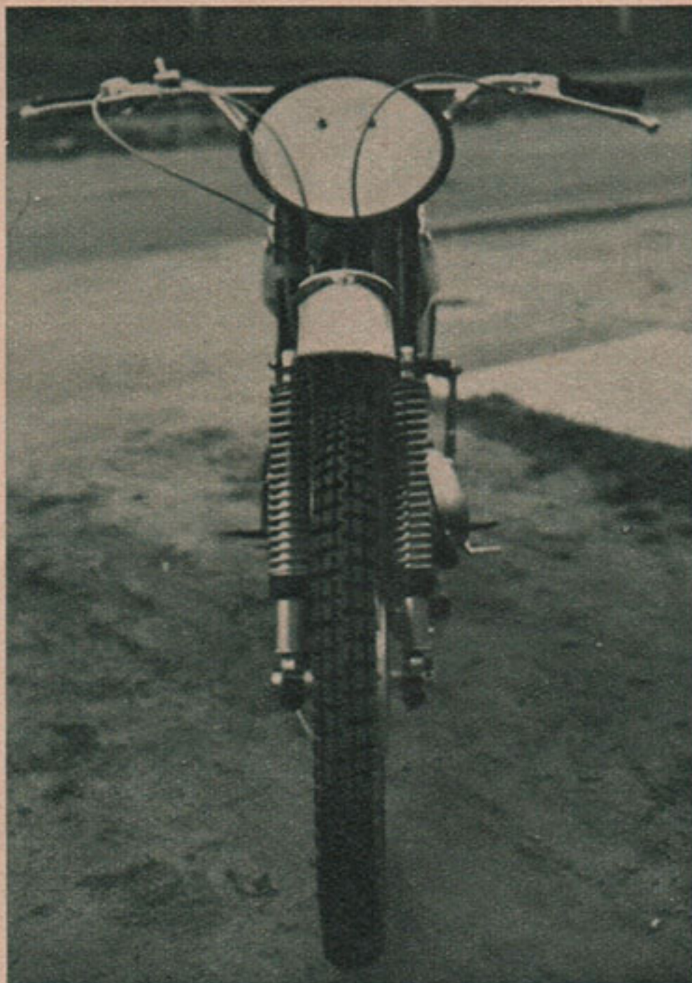
Der Blick von vorn auf die RMZ von Radke zeigt, wie schmal sie insbesondere auch in der Partie des Motorblocks dank der an der Zündanlage vorgenommenen Änderung geworden ist — wichtige Voraussetzung für den Geländeeinsatz.
