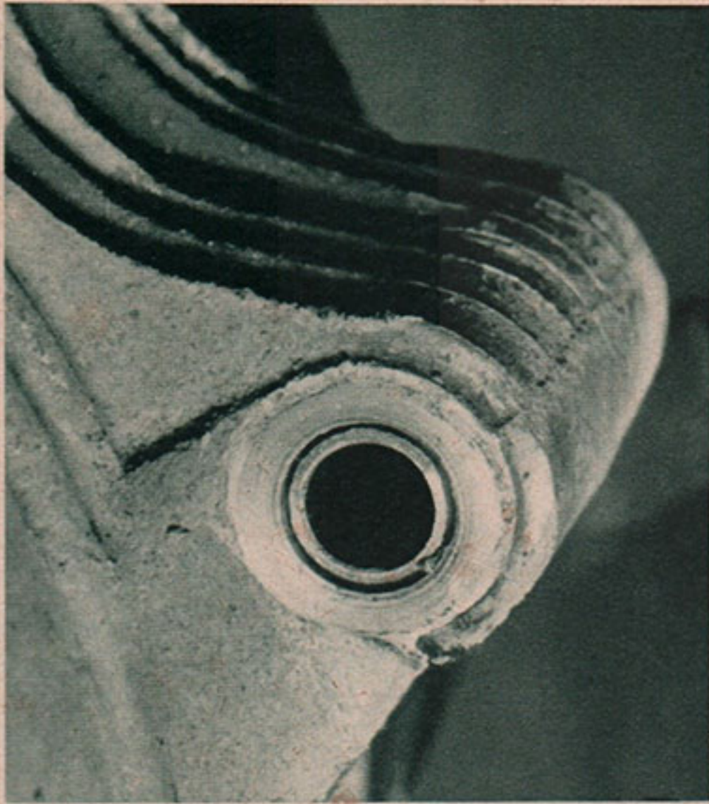
Links: Man sieht an vielen Kleinigkeiten, daß bei der Konstruktion eine Menge Erfahrungen verwertet wurden. Hier die Motor-aufhängung vorn, gegen ovales Ausschlagen der Bohrung wurde sie mit einer Stahlbuchse geschützt. Vielleicht sieht man in Zukunft an dieser Stelle noch eine Gummilagerung vor, um auf diese Weise die Vibrationen des Motors etwas mehr vom Fahrwerk fernzuhalten.
