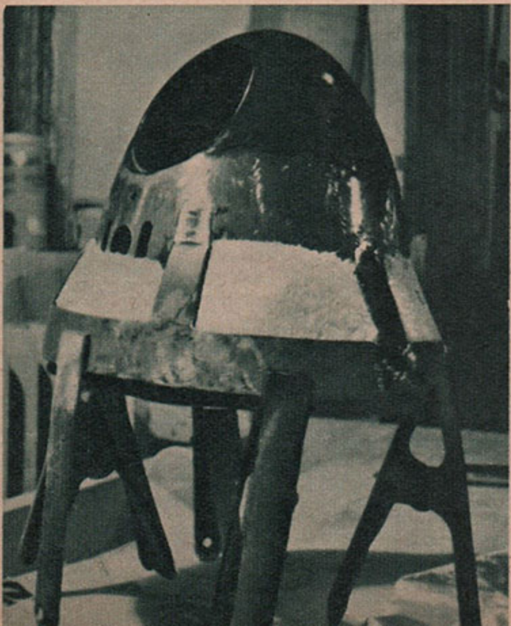
Die Bilder oben zeigen den langen Scheinwerfer und die Streuscheibe, die bei mir jetzt zwei Jahre lang ihre Pflicht tun. Die Bilder unten verdeutlichen die Arbeitsmethode mit Schaumstoff und glasfaserverstärktem Kunstharz für den Scheinwerfer an der Max unseres Lesers Günter Schapka.
