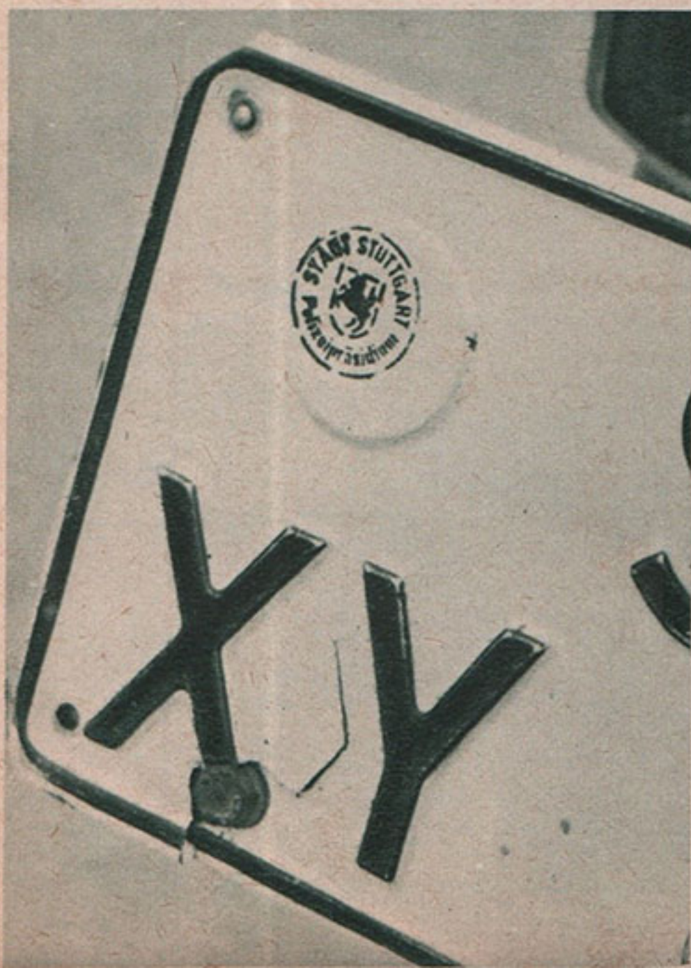
Aufpassen muß man auf Kleinigkeiten: der verlorene Niet im Bild links verursachte den Riß im Nummernschild. Vielleicht wäre ein etwas aufwendiger Schildhalter angebracht (Kunststoff?). Im Bild rechts das Testflorett nach 15 000 km: es sieht äußerlich fast neu aus, bis auf die Lackschäden vom Stiefel überall, auch im Chrom, noch blitzblank. Gepflegt wurde nicht übermäßig!
