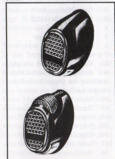
oben: SKR 62 (darunter SBKR 62, also mit Bremslicht), lackiert oder verchromt, Kabelzuführung von unten, Abstand der Befestigungsschrauben zwischen 52 und 71 mm. Verwendung: NSU Lux, Adler M 100, Dürkopp MD 200, 200er Hoffmann, Hercules 125 ccm, Maico
