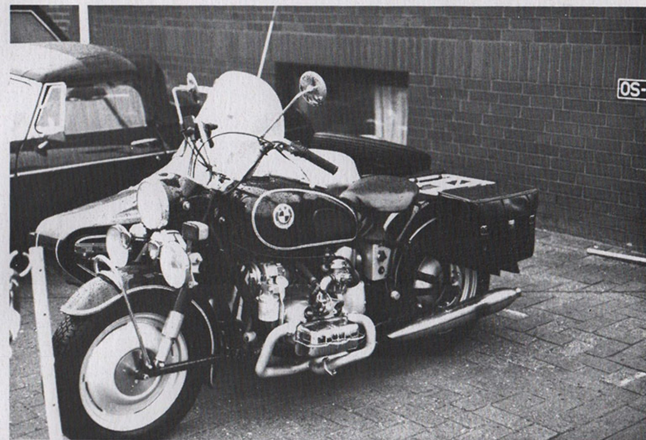
eben: Eines der vielen Selbst- bau-Gespanne. BMW-Rah- men mit Goliath-Hansa- 1100-4 Zyl.-Boxermotor Leistung um 55 PS, Wasser- gekühlt, Lloyd-Autofelgen
