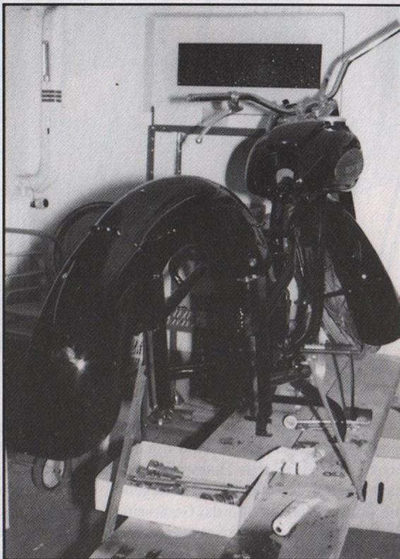
Foto links unten: Teilmontierte Telegabel; hier zeigte sich der sinnvolle Einsatz neuer Schrauben
