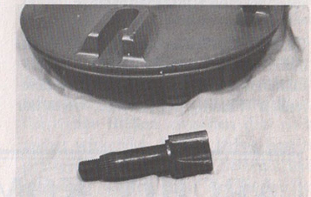
In Nocken und Welle sollte das Schmiermittel ganz dünn "einmassiert" werden.
