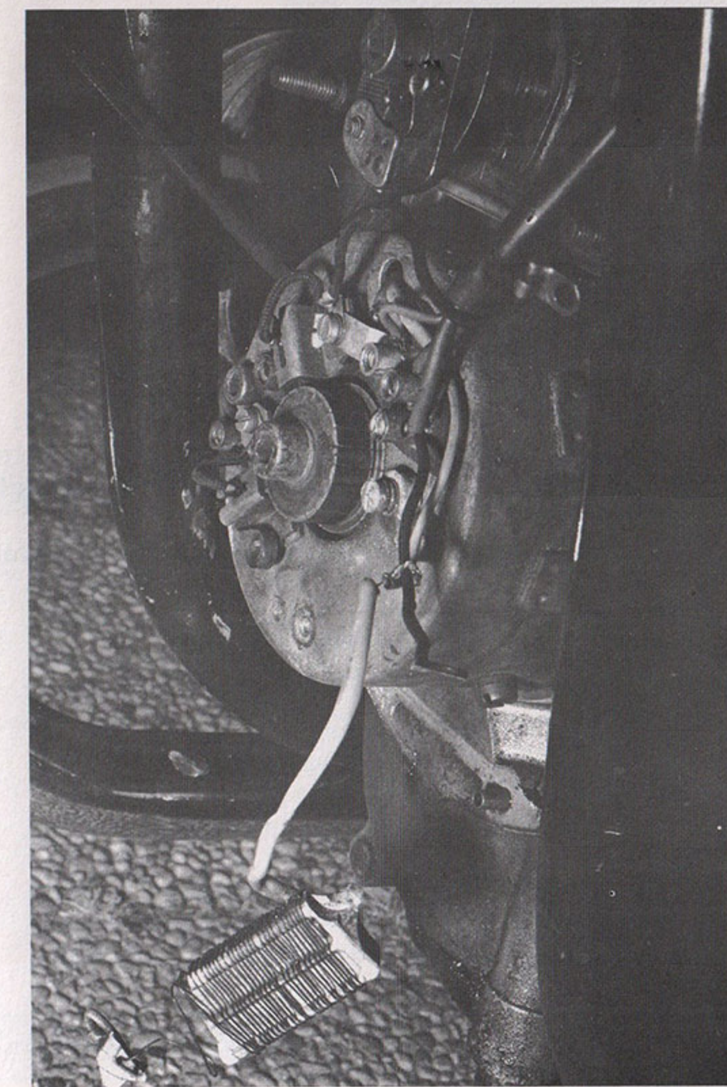
oben: Der genau in das LIMA-Gehäuse passende elektronische Regler aus Uli's Motorradladen, Frankfurt (Foto Kurze) unten: Auf diese Spule (Widerstand) kann man, bei Verwendung des elektronischen Reglers, verzichten (Foto Kurze)
