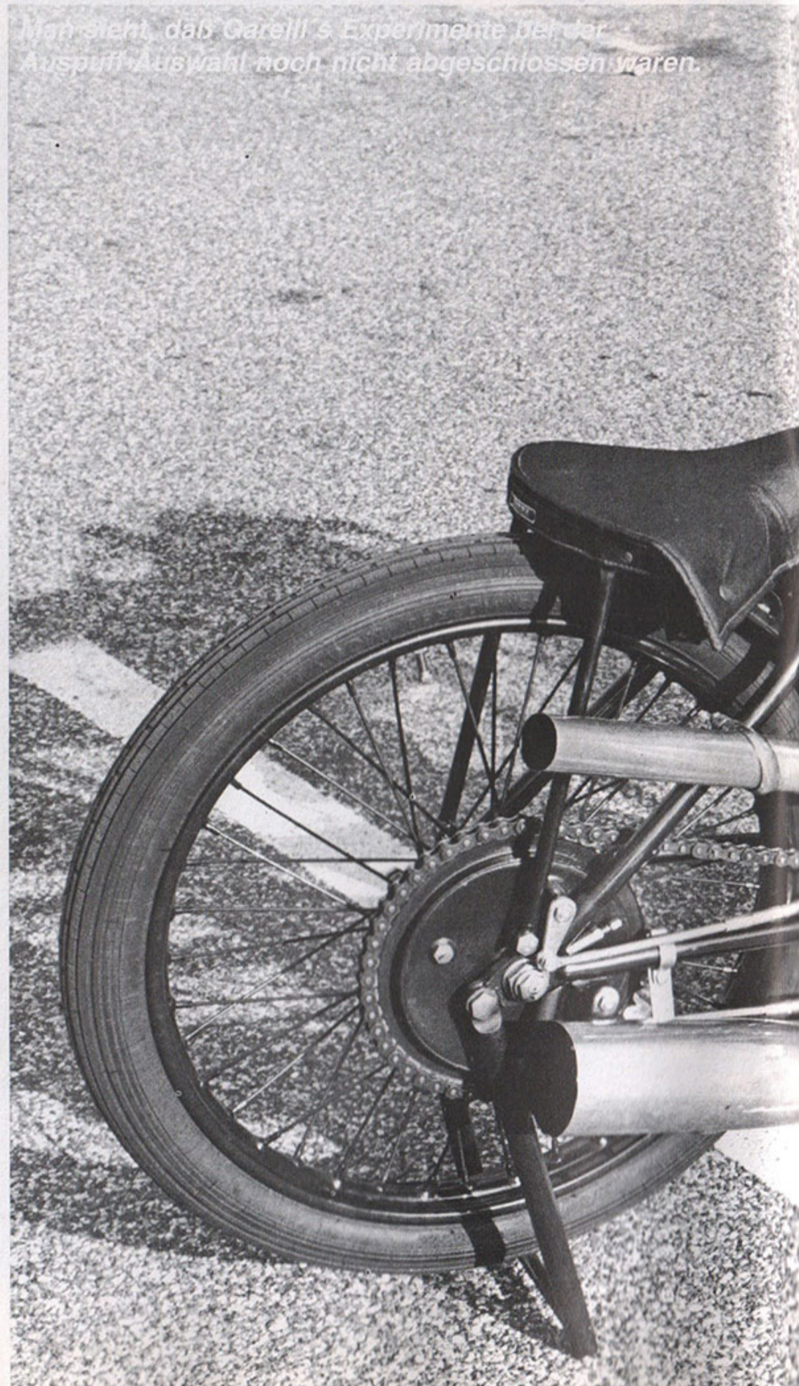
oben: 150 mm Simplexbremse (Garelli-Eigenbau). unten: Für jeden Fuß eine Nocke: 190 mm Doppel-Simplexbremse.
