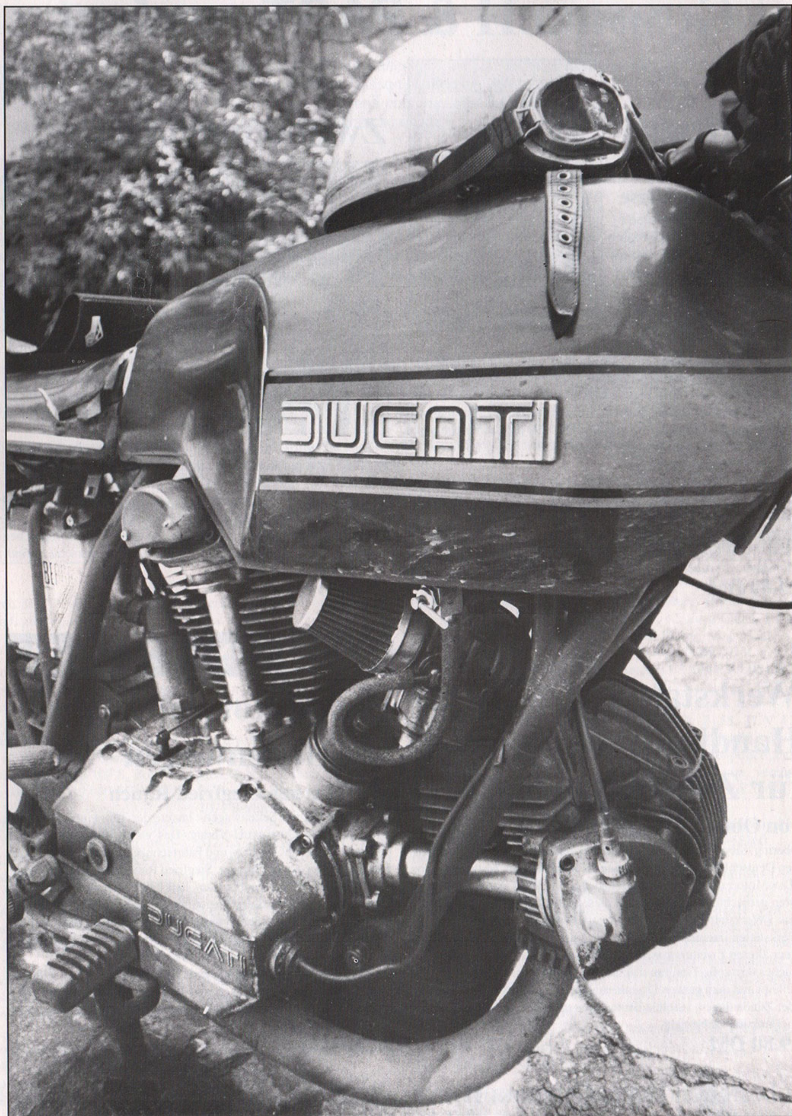
Nicht waschen! Testfahrzeug. Am Kegelantrieb des stehenden Zylinders ist die Lucas-Rita Zündung untergebracht (Foto: Jordan)
