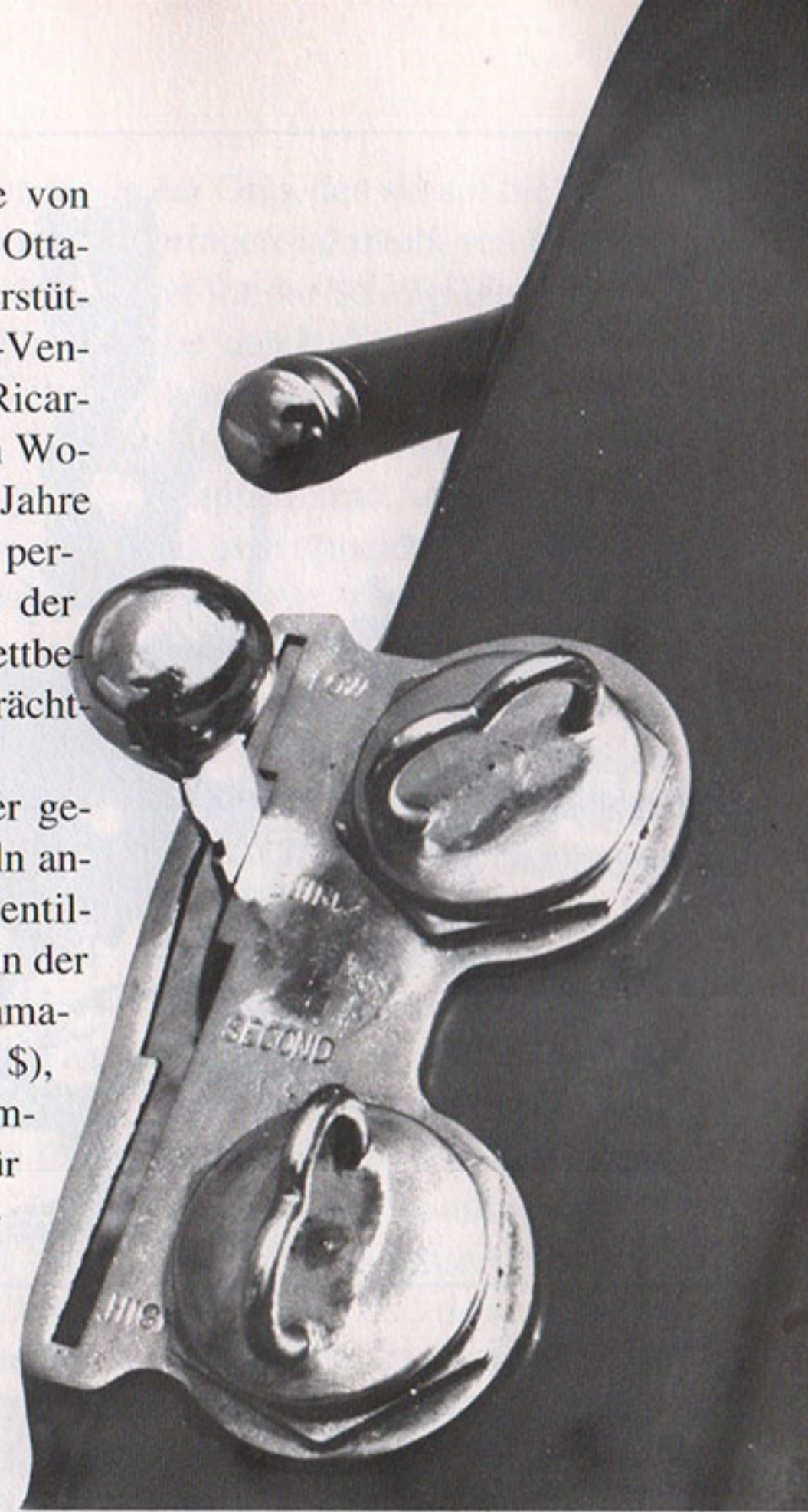
Schalthebel und Oelhandpumpe an der linken Tankhälfte
