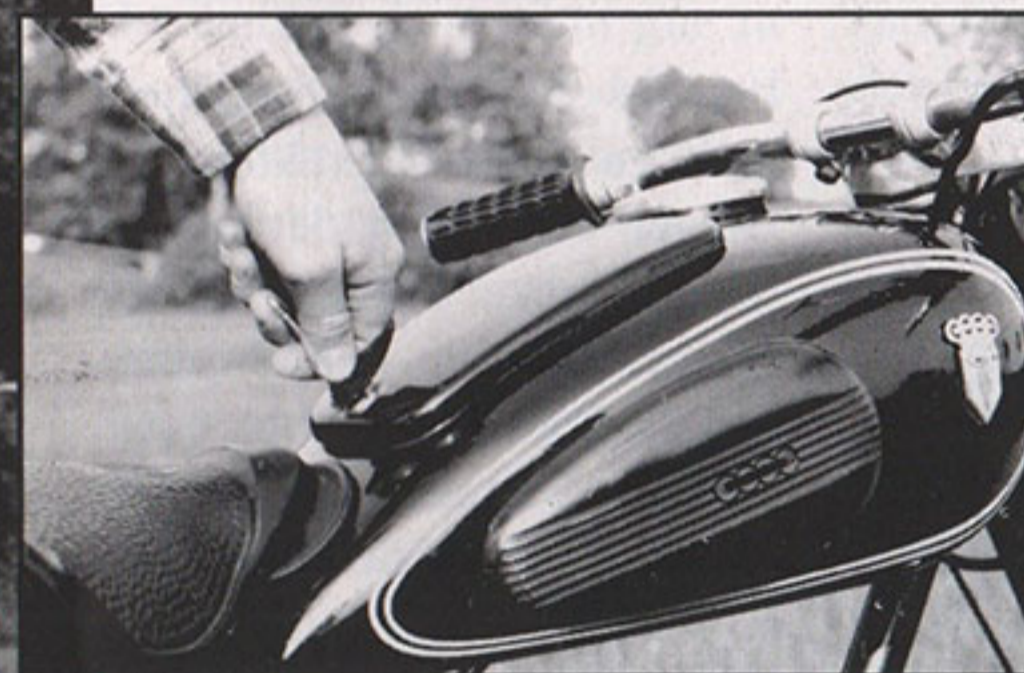
Das Werkzeugfach auf dem Tank ist abschließbar
