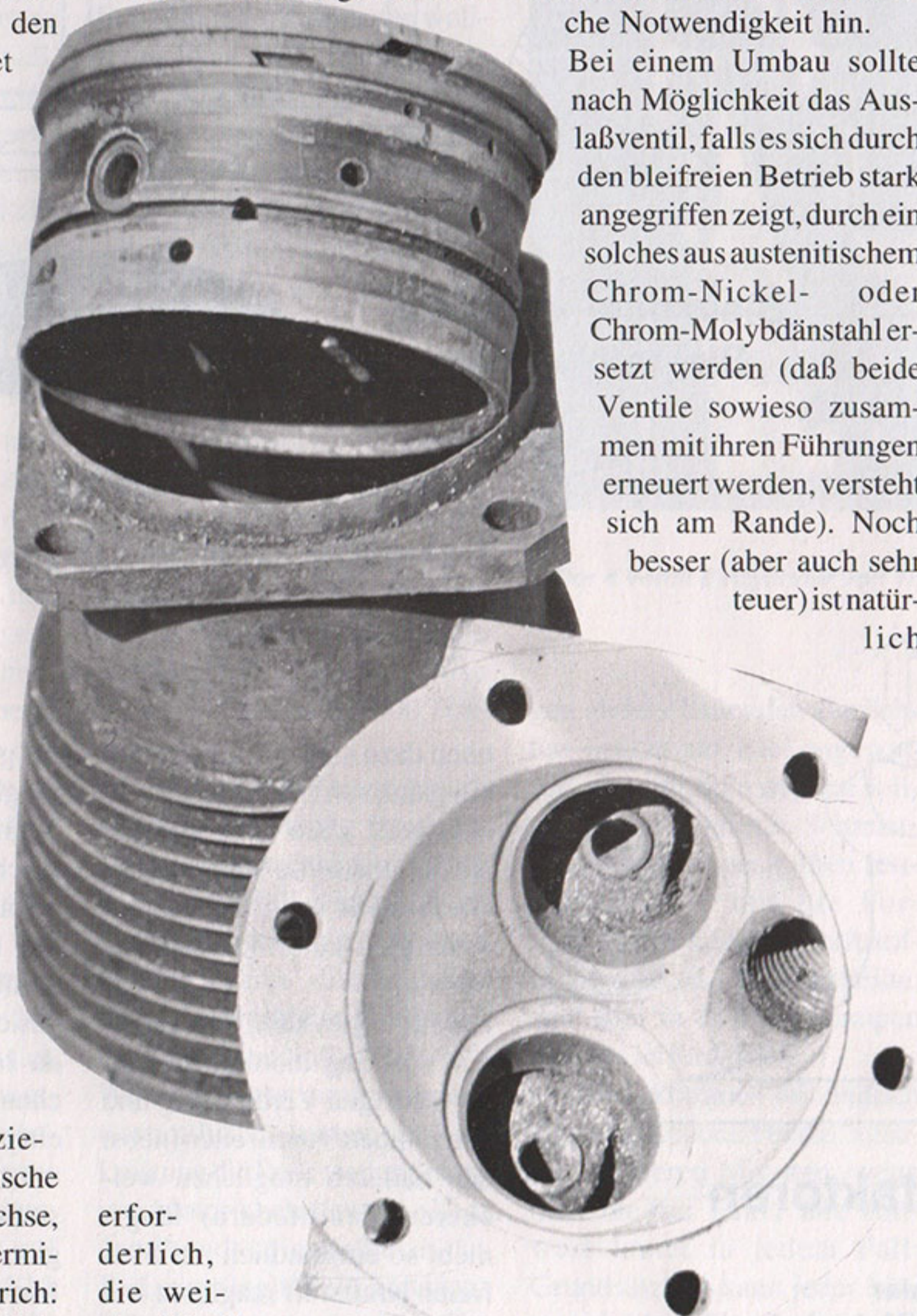
Die Ventile haben sich in dem OHV-Zylinderkopf schon bequem niedergelassen (Foto Longstro-ke)
