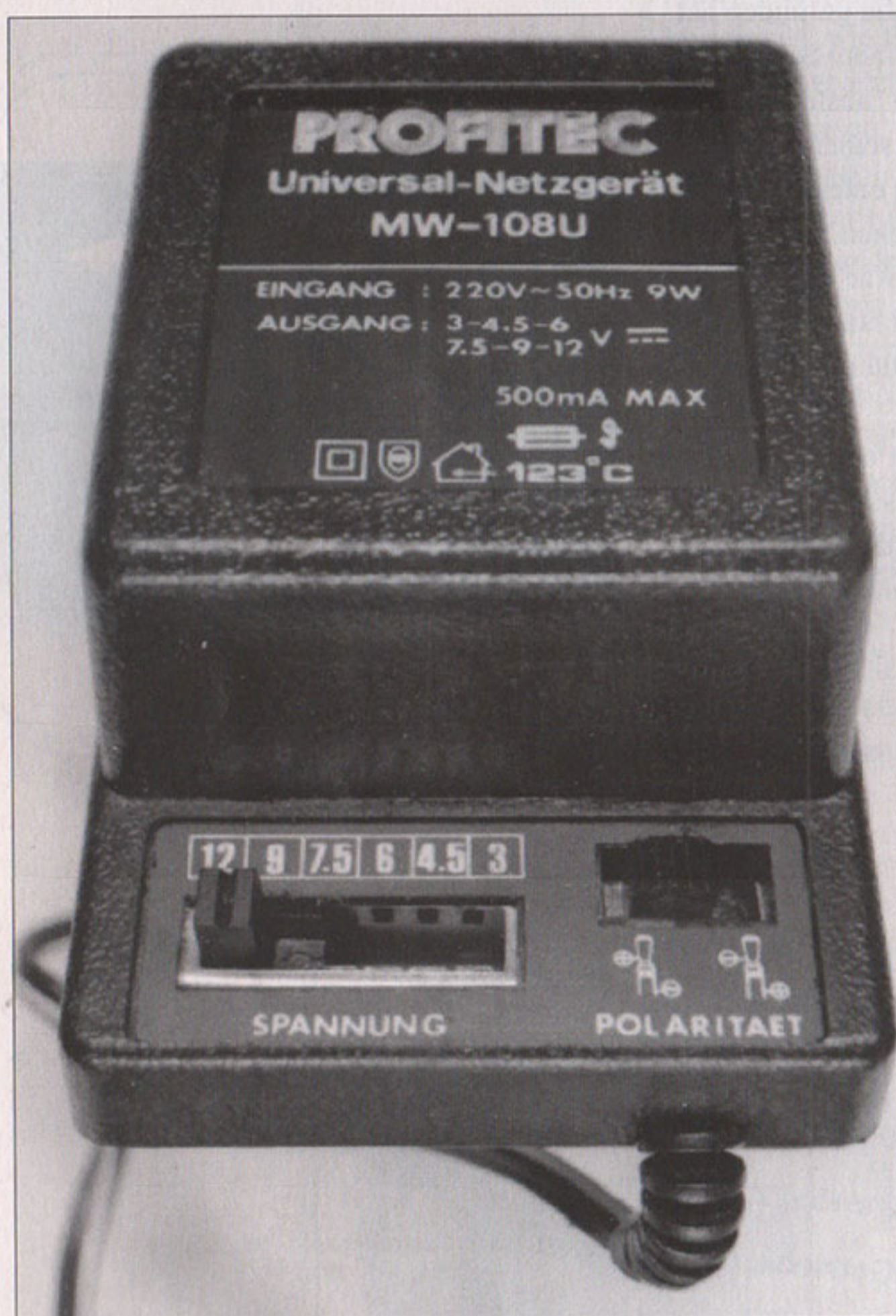
Ladegerät für Akkus - mit einstellbarer Spannung - mit geregelterm Strom - gegen Kurzschluß und Verpolung geschützt - mit Strom- und Spannungskontrolle
