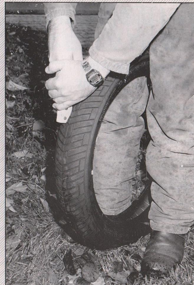
Gilstern: Der Reifen wird zwischen die Knie geklemmt, am besten fertig montiert und aufgepumpt, und mit dem Hobel bringt man Schnitt für Schnitt Längsrillen auf der gesamten Lauffläche an. Am wichtigsten sind die Profilflanken, da sie in der Kurve führen.
