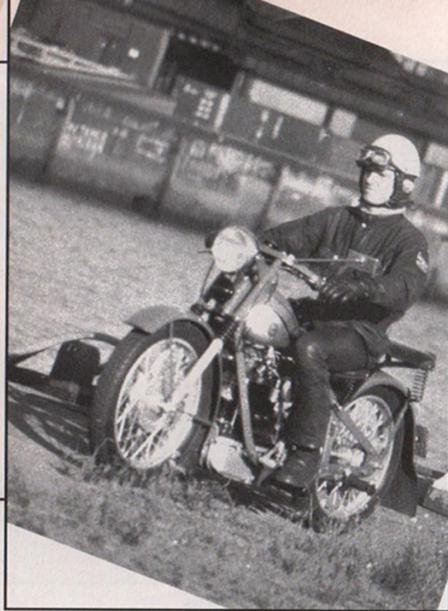
ber ein Auto und sogar dem Militär war die Konstruktion inzwischen zu veraltet. Speziell für Behörden wurde die Nimbus von Anfang an für Gespannbetrieb ausgelegt, die Firma stellte eigene Seitenwagen her, es wurden aber auch andere Fabrikate angebaut. Die Rahmenkonstruktion der Maschine macht nicht gerade den Eindruck, als sei sie auf hohe Querbelastung ausgelegt, hielt aber allen Beanspruchungen stand. Der Anblick der spackeligen Telega-
