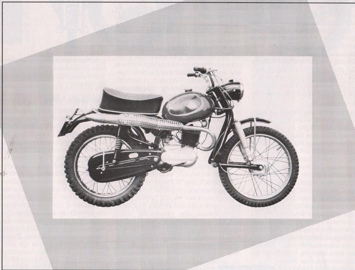
ren Federbeine lassen sich (mit ihren kurzen Hebeln gerade noch) ohne Werkzeug verstellen; die Durchschlagsicherheit ist auch bei Sozusbetrieb voll ausreichend, zumal die hinteren Fußrasten direkt an der Schwinge angesetzt sind, aber ziemlich vorn, so daß die Federbewegungen praktisch nicht stören. -
