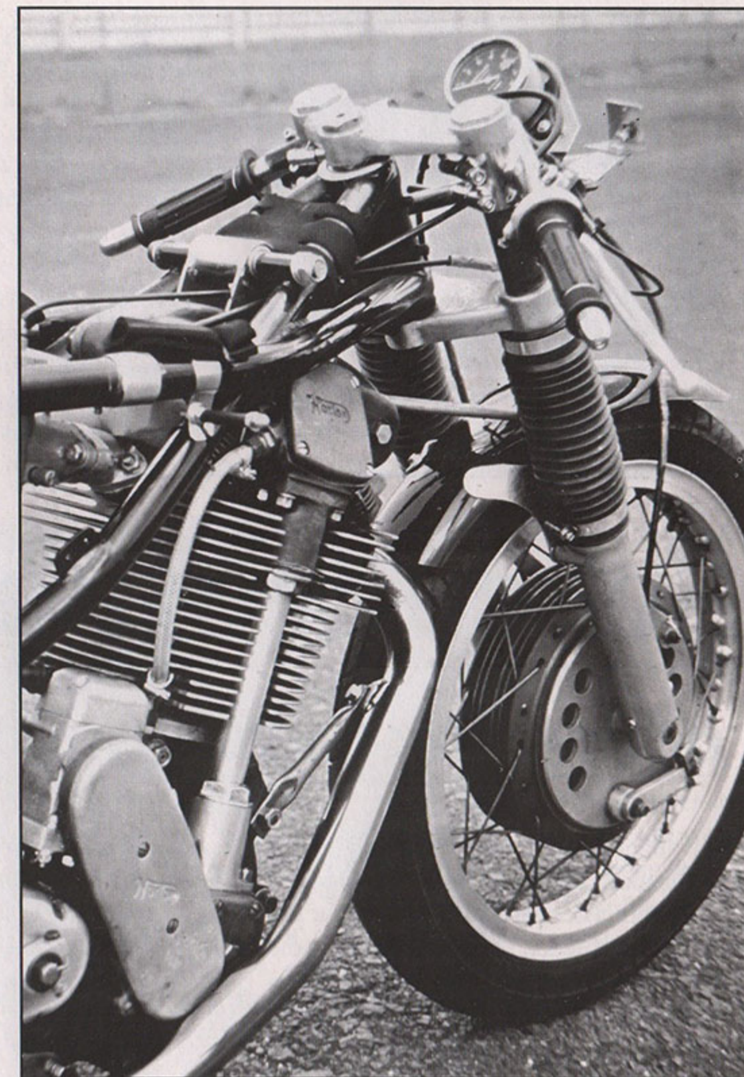
Foto rechts : 200 mm legt der Kolben bei jeder Umdrehung in diesem Motor zurück !!
