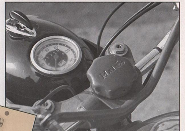
Oben: Lenkungsdämpfer und Ganganzeige im Tacho.
