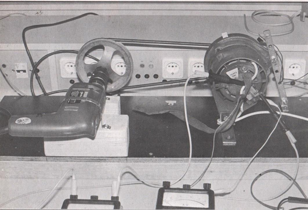
Bild 6c: Improvisationen haben ihre Tücken: Während des Versuchs rutschte der Keilriemen, und die Bohrmaschine wurde heiß.
