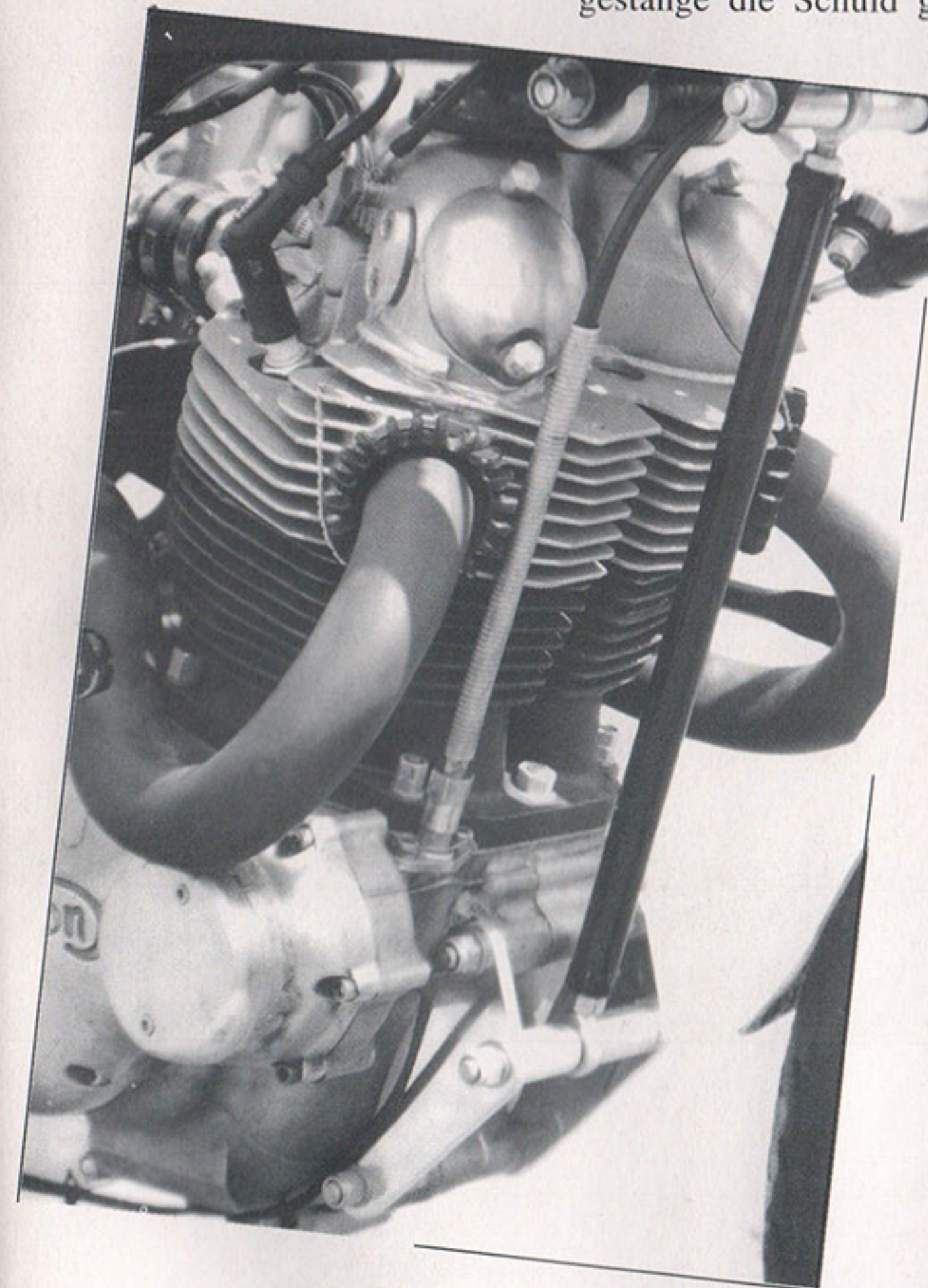
Das von Richard Pekett nachgrüstete vordere Halterohr mit Kugellagern zur automatischen Hitzeanpassung.
