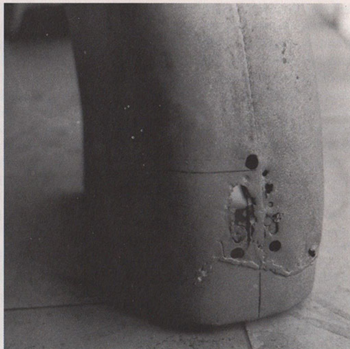
Kotflügel mit Durchrostung und alter Schadensstelle ...
