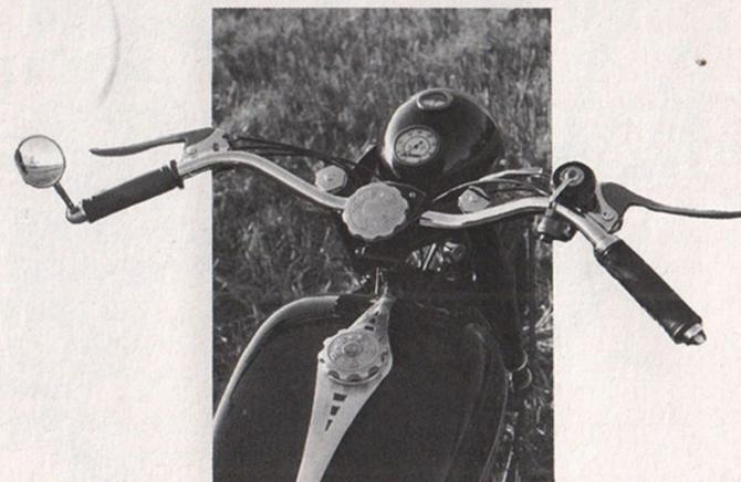
hebelnocken am äußeren Nockenring vorbei. Durch die induzierte Spannung der im Kraftfeld eines Hufeisenmagneten liegenden Spulen funkte es bei jedem Unterbrechen der Zündkontakte. Die Einstellung des Zündzeitpunktes zwischen Früh- und Spätzündung geschah manuell mittels Verdrehen des Nockenrings über einem kleinen Verstellhebel an der linken Lenkerseite.
