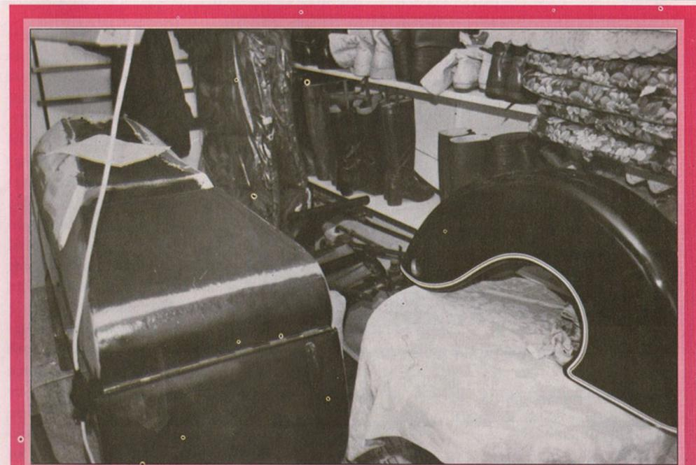
*Rostschutz am Unterboden bis zur ersten Zierleiste neu aufgebaut, Kotflügel fertig. Unterboden neu beschichtet (Unterbodenschutz und Kunstharzlack).*
